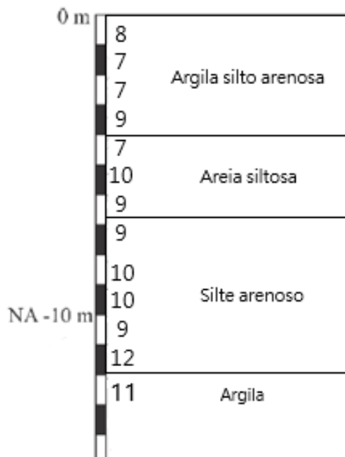
Figura 2: Sondagem geotécnica (SPT).
