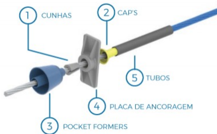
Figura 4: Modelo de ancoragem tipo AF.
