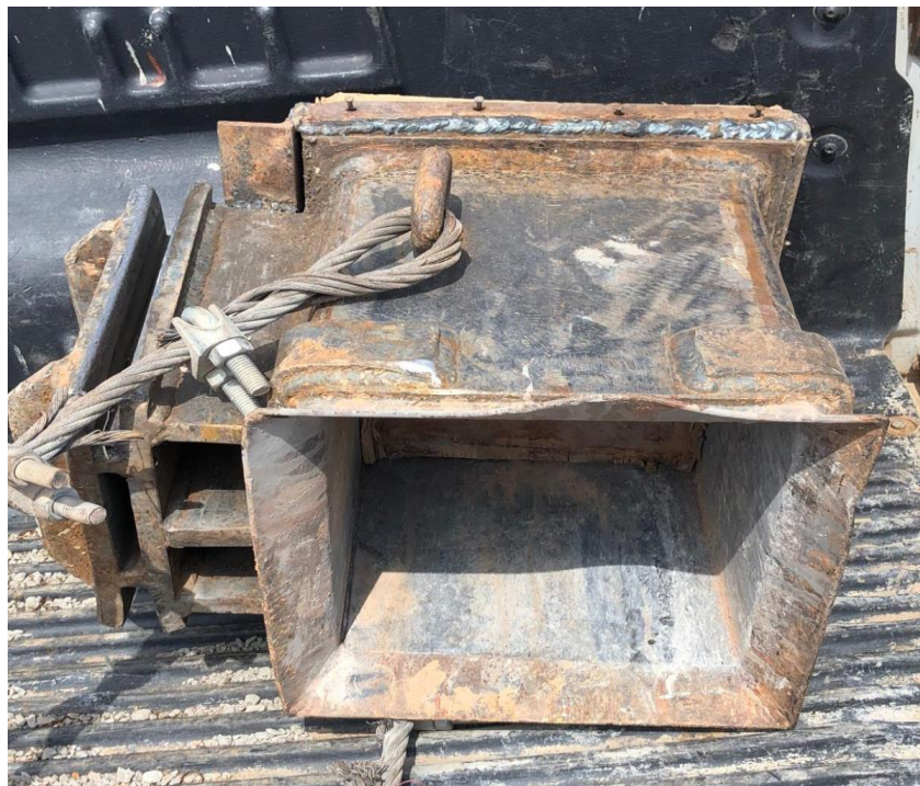
Figura 4: Capacete do equipamento bate estaca (K2)
