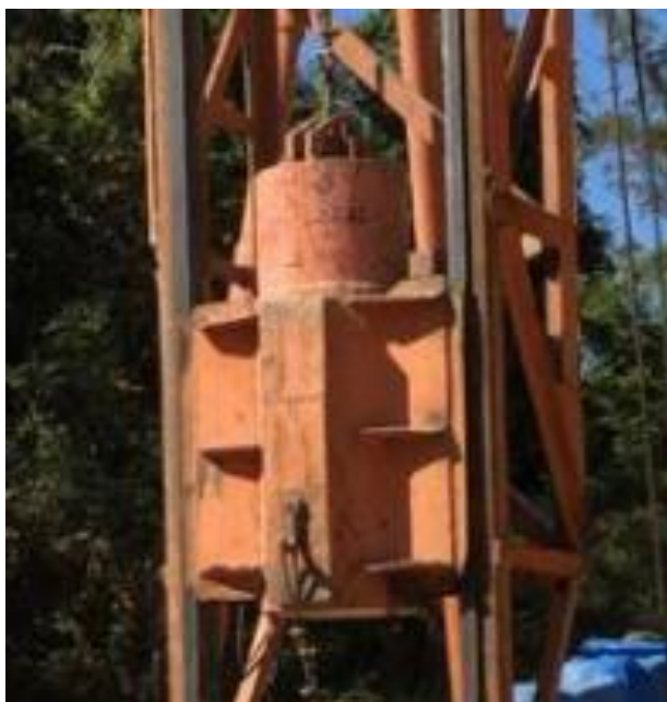
Figura 2: Martelo utilizado em cravações de elementos pré-moldados
