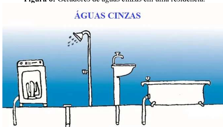
Figura 6: Geradores de águas cinzas em uma residência.
