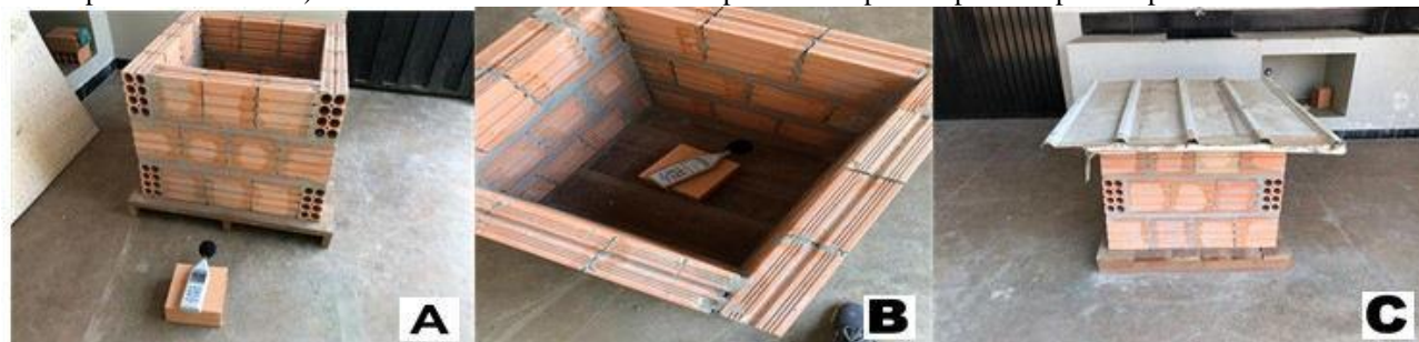
Figura 4: Posicionamento do decibelímetro A) a frente dos blocos de cerâmico; B) no interior dos blocos de cerâmico com superfície aberta e C) dentro dos blocos cerâmicos com placa de isopor tampando a parte superior
