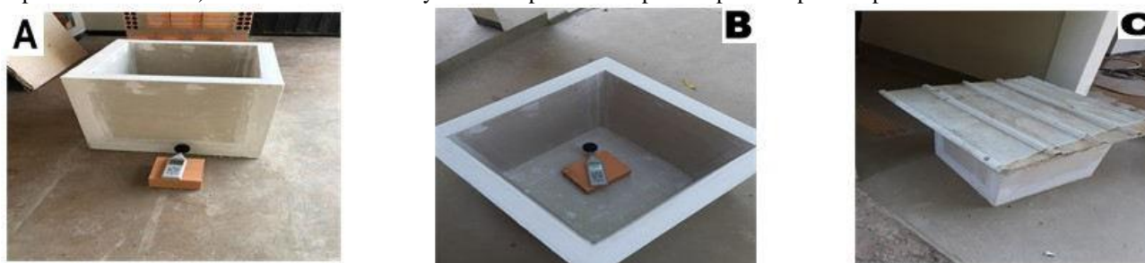
Figura 5: Posicionamento do decibelímetro A) a frente do molde de drywall; B) no interior do molde de drywall com superfície aberta e C) dentro do molde de drywall com placa de isopor tampando a parte superior
