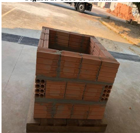
Figura 2: Cubo de alvenaria
