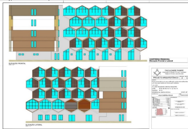
Figura 36: Elevações da Fachada Frontal e Lateral
