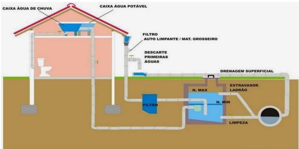
Figura 27- Captação da água da chuva
