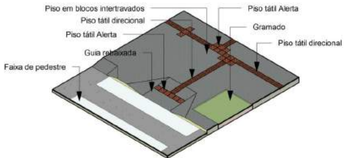
Figura 22: Rampa de acesso da via pública a calçada e piso tátil da calçada
