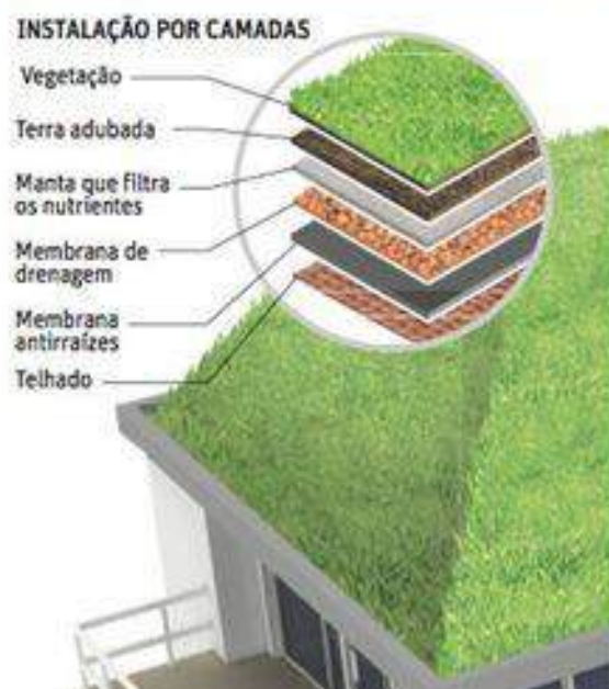
Figura 41: Camadas do telhado verde
