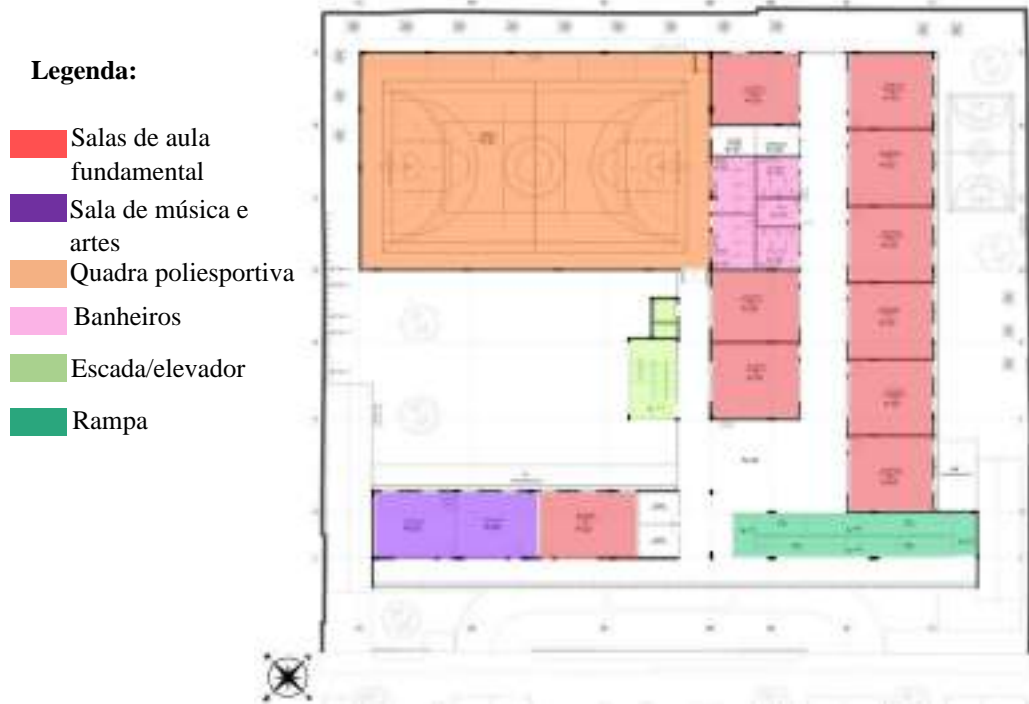
Figura 17: Planta baixa segundo pavimento, Escola Red House
