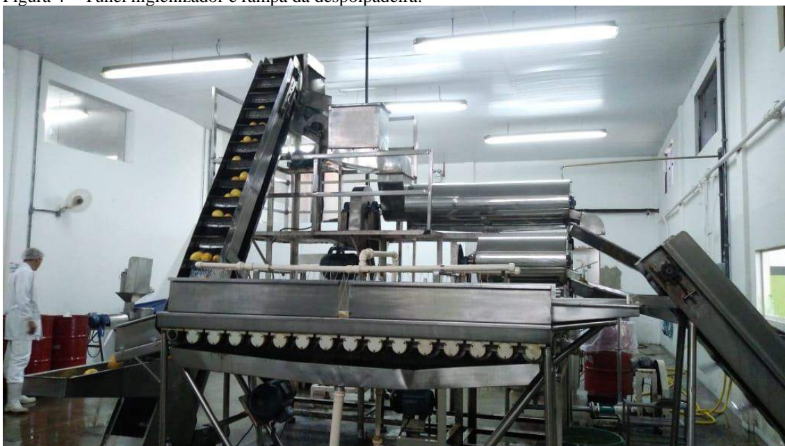
Figura 4 – Túnel higienizador e rampa da despulpadeira.
