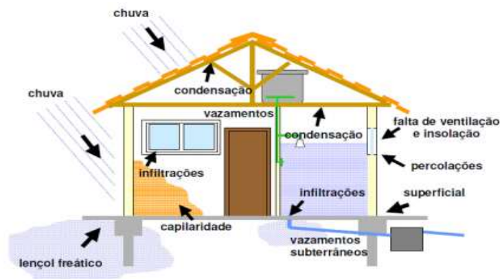
Figura 3: Atuações dos fluidos em uma mesma edificação.
