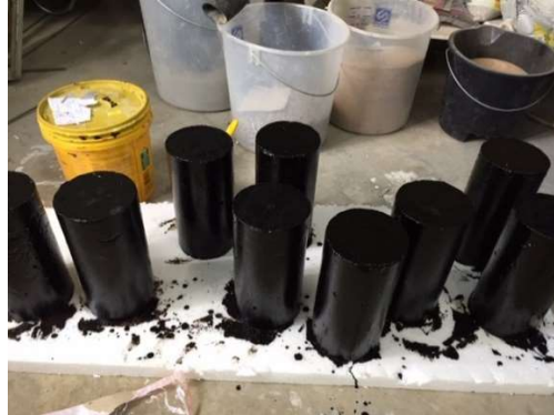
Figura 4: Amostra da aplicação dos impermeabilizantes
