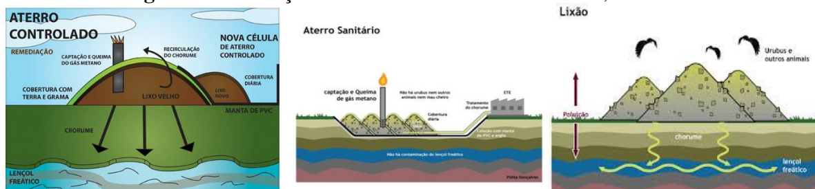
Figura 3: Diferença nas camadas de aterro controlado, aterro sanitário e lixão.
