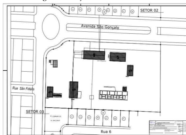
Figura 10: Layout do canteiro de obras
