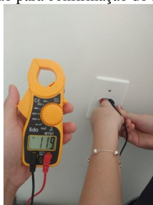
Figura 15: Medição de tensão para confirmação do funcionamento do multímetro
