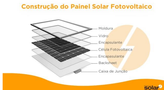
Figura 4: Construção do painel solar fotovoltaico
