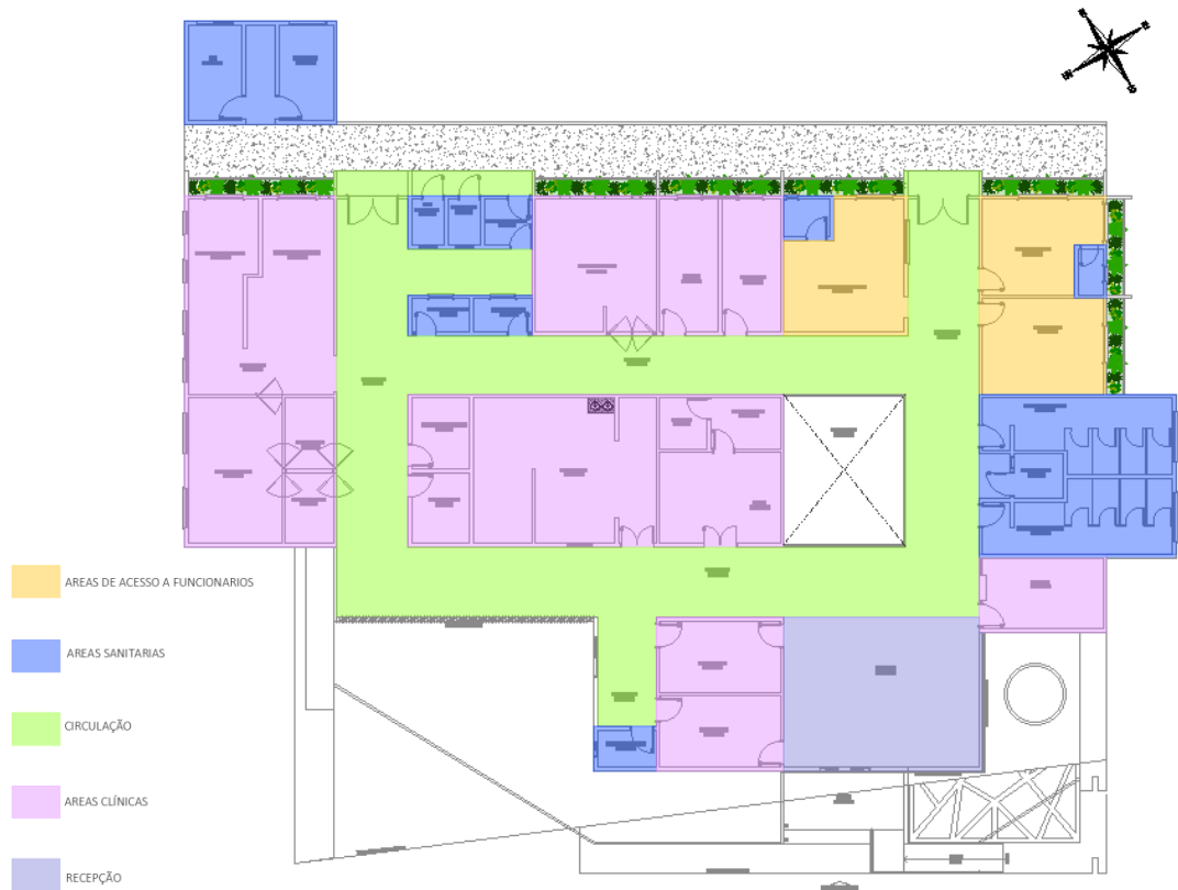
Figura 30: Setorização bloco A
