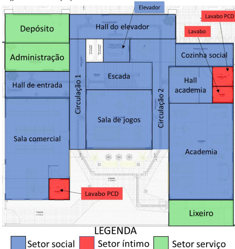
Figura 27 – Setorização pavimento térreo.
