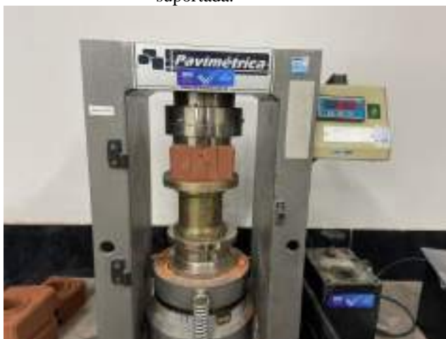
Figura 16: Tijolo solo-cimento no momento em que ocorre a falha registrando sua carga máxima suportada.
