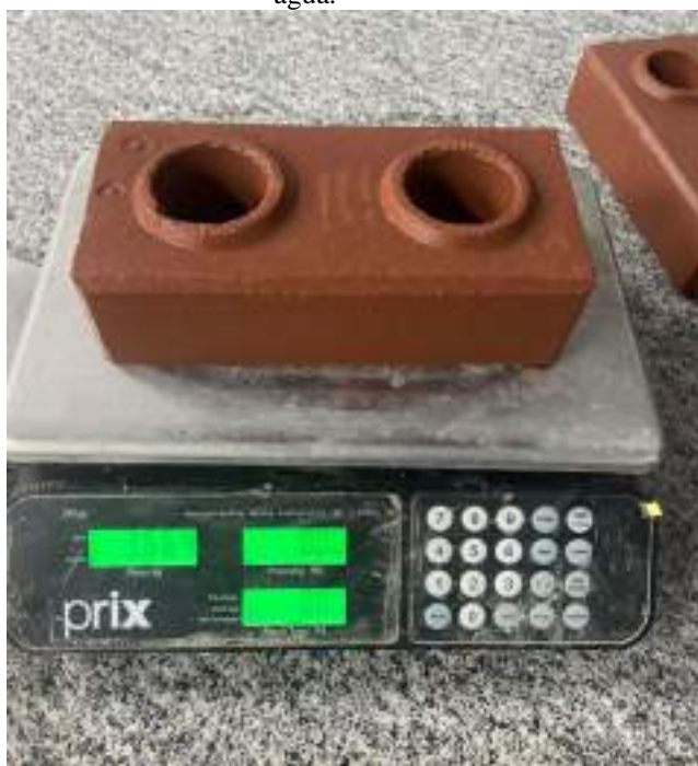
Figura 18: Tijolo solo-cimento posicionado sobre balança de precisão após processo de imersão em água.
