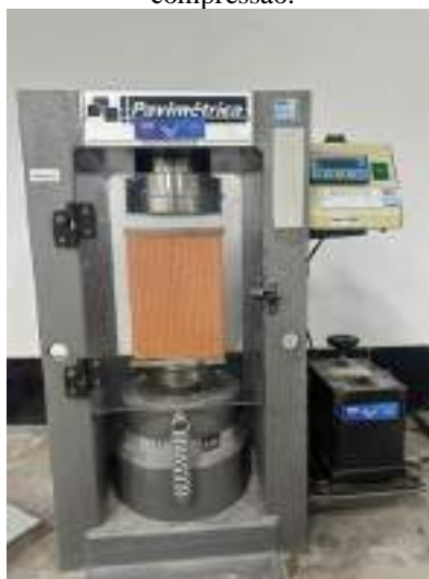
Figura 15: Bloco cerâmico adequadamente posicionado durante o ensaio de resistência a compressão.
