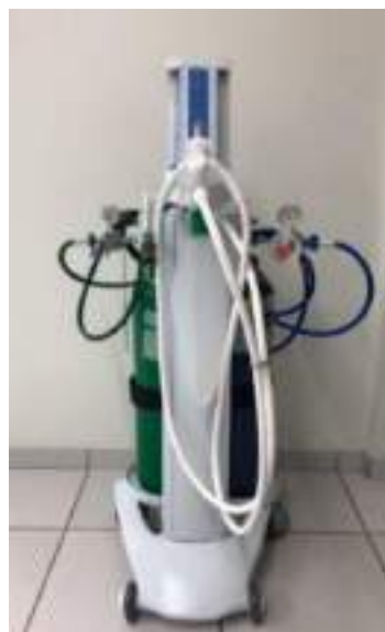
Figura 15: Sistema de engates de mangueira para a mistura dos gases
